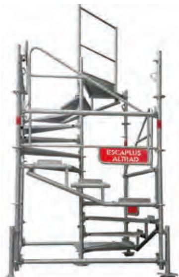
Compact, avec des dimensions de 1,50 m x 1,50 m (entraxe poteaux) et 1,75 m x 1,75 m (hors tout), **ESCAPLUS** offre une hauteur utile de 2,40 m et une hauteur totale de 3,10 m. Chaque module est entièrement démontable, facilitant le rangement en châssis, et ses pièces légères et peu encombrantes simplifient le transport.
