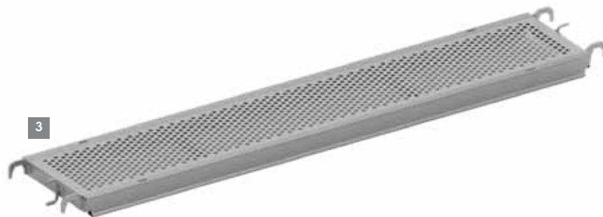
4 PLANCHON ACIER 200 Longueur : 1000mm - 7,3kg - réf : KMH2 Longueur : 1500mm - 10,1kg - réf : KMH3 Longueur : 2000mm - 13,1kg - réf : KMH4 Longueur : 2500mm - 15,9kg - réf : KMH5 Longueur : 3000mm - 18,6kg - réf : KMH6
