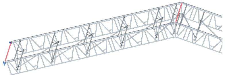
Les lisses rouleaux (en rouge ci-dessus) facilitent la mise en place des bâches. Elles se fixent sur les compresseurs et sur la poutre de faîtage.
