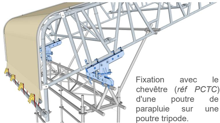
Fixation avec le chevêtre (réf PCTC) d'une poutre de parapluie sur une poutre tripode.
