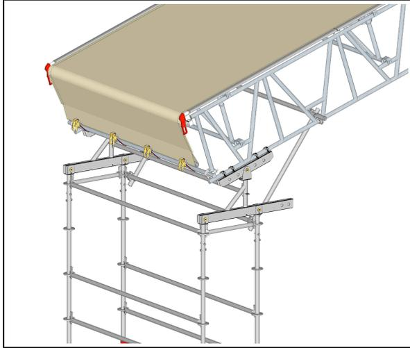
A gauche, fixation de la bâche sur la poutre ALTRIX.
