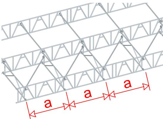
Moment admissible dans la poutre: 4192 daN.m avec un laçage de 1m, et 3267 daN.m avec un laçage de 2m
