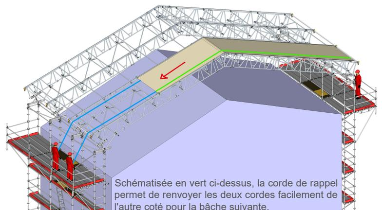
Schématisée en vert ci-dessus, la corde de rappel permet de renvoyer les deux cordes facilement de l'autre côté pour la bâche suivante.
