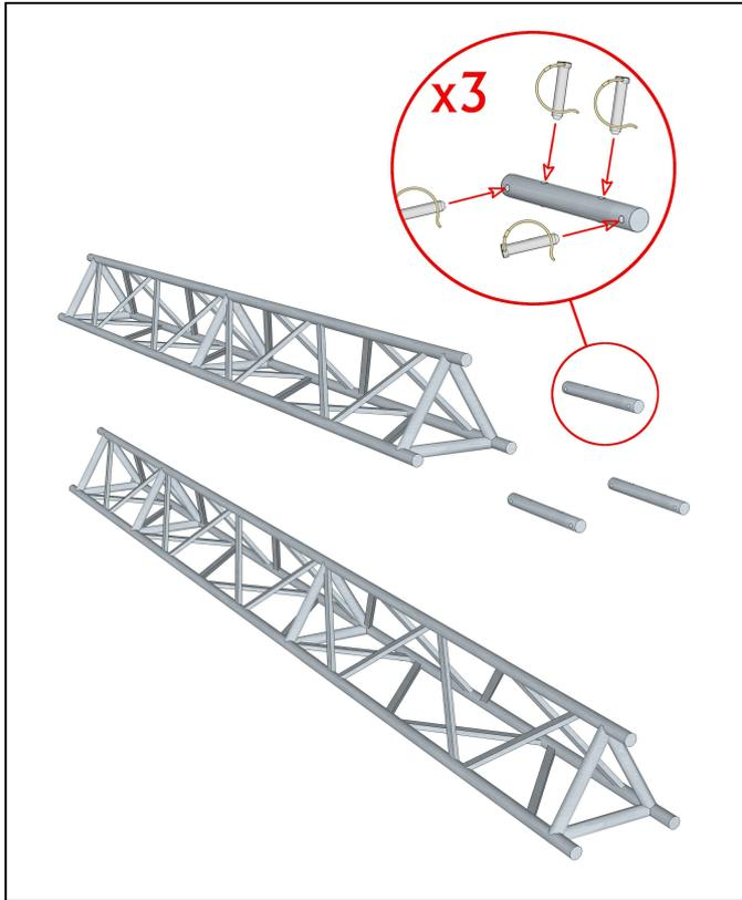
Les poutres tripodes de longueurs 4.00m et 5.00m permettent, la fixation des fermes sur l'échafaudage.
