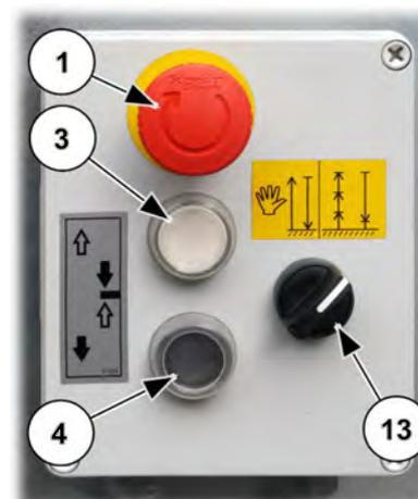
III. 51: Commande au sol pour le dispositif de protection (AUTOMATIQUE)
