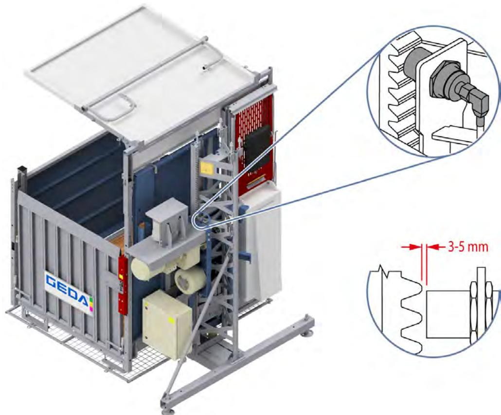
III. 62: Protection contre les dépassements et protection du câble
