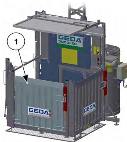
III. 27: Plateforme avec rampe du côté avant
