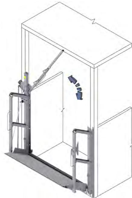
III. 33: Fermer la barrière avec verrouillage mécanique
