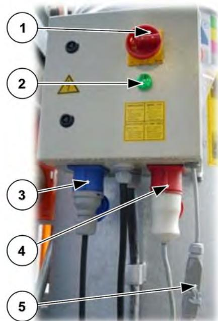
III. 13: Coffret de commande de la station au sol
