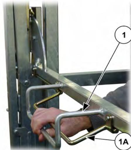
III. 32: Ouvrir la barrière avec verrouillage mécanique
