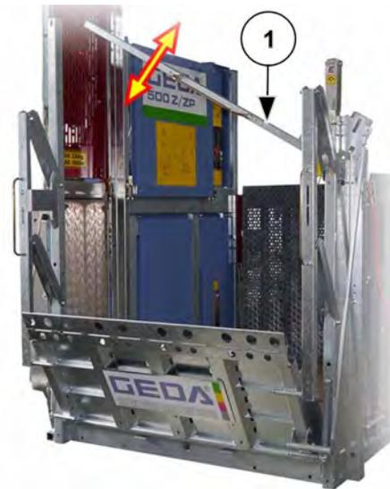
III. 35: Ouvrir/fermer la barrière avec verrouillage électromécanique
