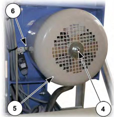
III. 76: Dispositif de freinage avec interrupteur de fin d'urgence
