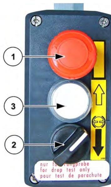
III. 56: Commande des essais de freinage
