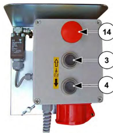
III. 52: Module électrique pour l'encagement d'accès sécurisé
