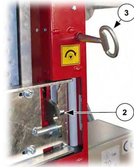
III. 29: Déverrouillage d'urgence de la rampe / Porte de chargement
