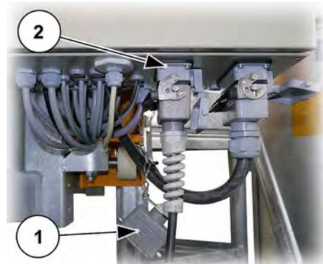
III. 74: Fiche isolante de la commande des essais de freinage
