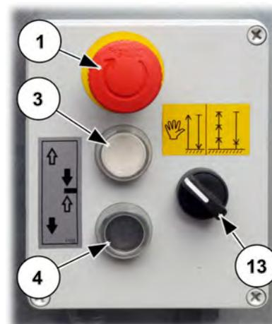
III. 49: Commande au sol pour le dispositif de protection (MANUEL)
