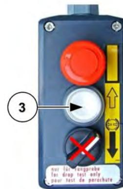
III. 72: Utilisation de la commande des essais de freinage
