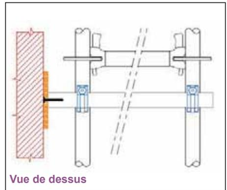
**Rappel pour être conforme à la norme EN 12811-1, les tubes libres qui composent ce type d'amarrage doivent être en diamètre nominal de 48.3mm, d'épaisseur nominale minimale de 3.2mm et présenter une limite conventionnelle minimale nominale d'élasticité de 235N/mm<sup>2</sup>.**
