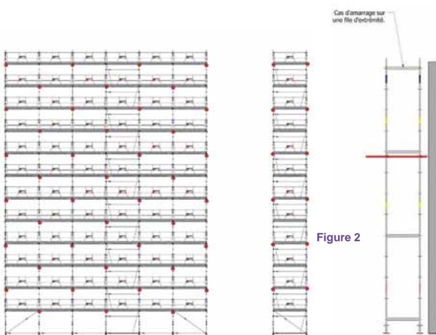
**Rappel : il est nécessaire d'installer au minimum 1 amarrage tous les 12m<sup>2</sup>. Si ces dispositions sont impossibles à respecter, faire valider par un bureau d'études les mises en place effectives.**
