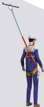
$$\text{Facteur de chute} = \frac{\text{Hauteur de chute}}{\text{Longueur de la longe}}$$
