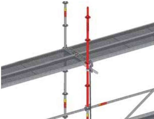
Point 2 : La pince est fixée sur la rosace d'un montant vertical, à l'extérieur, 1,00 m maximum au-dessus du niveau du plancher sur lequel se tient le monteur.
