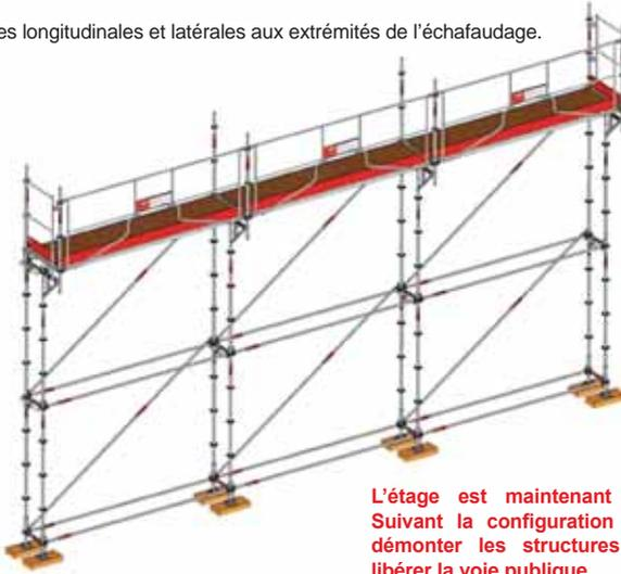
L'étage est maintenant totalement sécurisé. Suivant la configuration de montage choisie, démonter les structures provisoires afin de libérer la voie publique.
