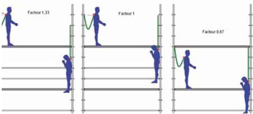
On privilégiera un ancrage à 1 m minimum au-dessus du plancher et sur des points d'ancrage validés par le fabricant.
