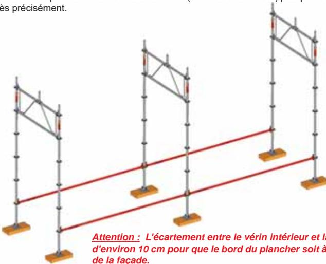
**Attention :** L'écartement entre le vérin intérieur et la façade doit être d'environ 10 cm pour que le bord du plancher soit à 20 cm maximum de la façade.
