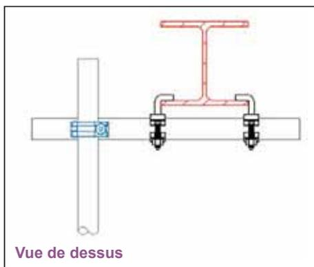
**Rappel pour être conforme à la norme EN 12811-1, les tubes libres qui composent ce type d'amarrage doivent être en diamètre nominal de 48.3mm, d'épaisseur nominale minimale de 3.2mm et présenter une limite conventionnelle minimale nominale d'élasticité de 235N/mm<sup>2</sup>.**
