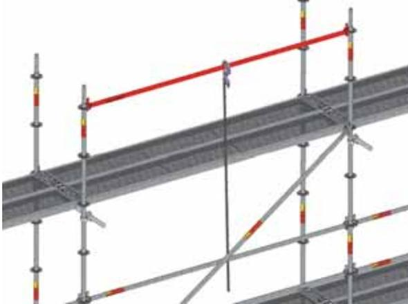
**Point 4 :** La pince est située sur la rosace d'un montant intérieur dont la jonction est située à 1m au maximum au dessus du niveau du plancher sur lequel se tient le monteur.
