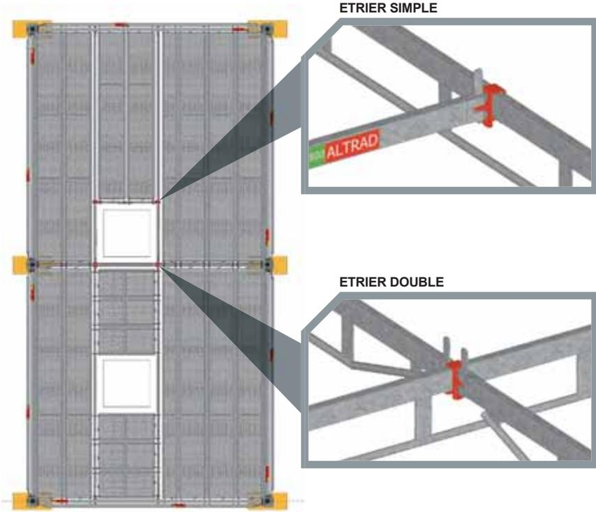
Afin d'interrompre une maille de planchers, utiliser les étriers simple coupe maille (réf. **NV959E**) ou les étriers double coupe maille (réf. **NV959F**). Ils permettent de fixer des traverses entre les planchers. Ainsi il est possible de combler la plateforme par les planchers les mieux adaptés dimensionnellement.
