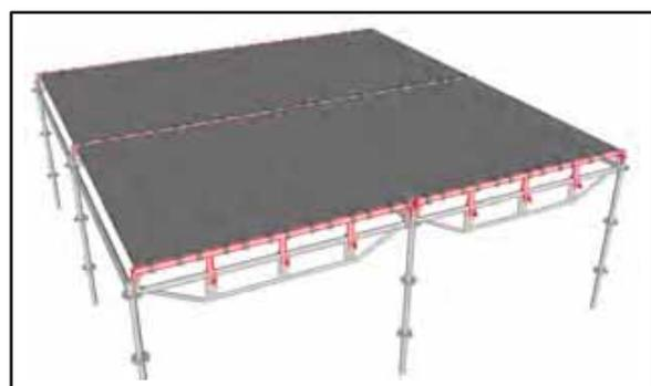
Représentation partielle d'un montage avec les réhausse plancher.
