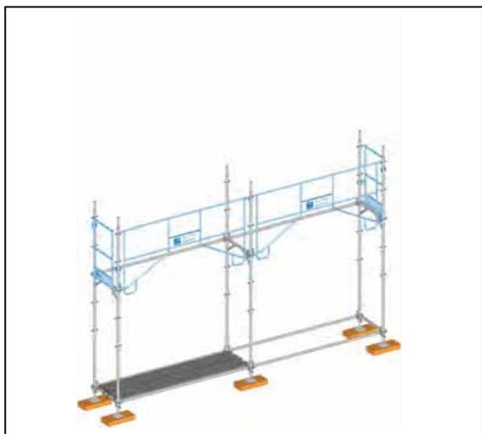
**8-** Mise en place d'une diagonale et d'une lisse à 1.50 mètre pour sécuriser l'accès par l'échelle.
