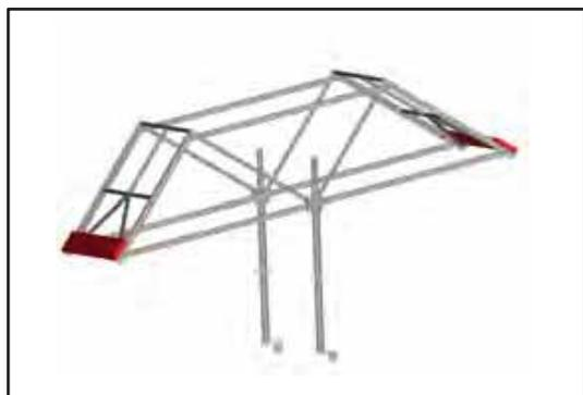
Schéma du garde-corps pour recette de matériaux. Repose sur deux étriers de départ (réf. KETR).
