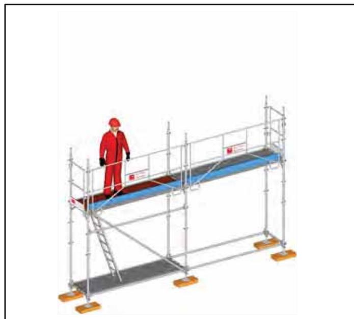
**11-** Ancrage à 4 mètres et montage, ainsi de suite, jusqu'au dernier niveau.
