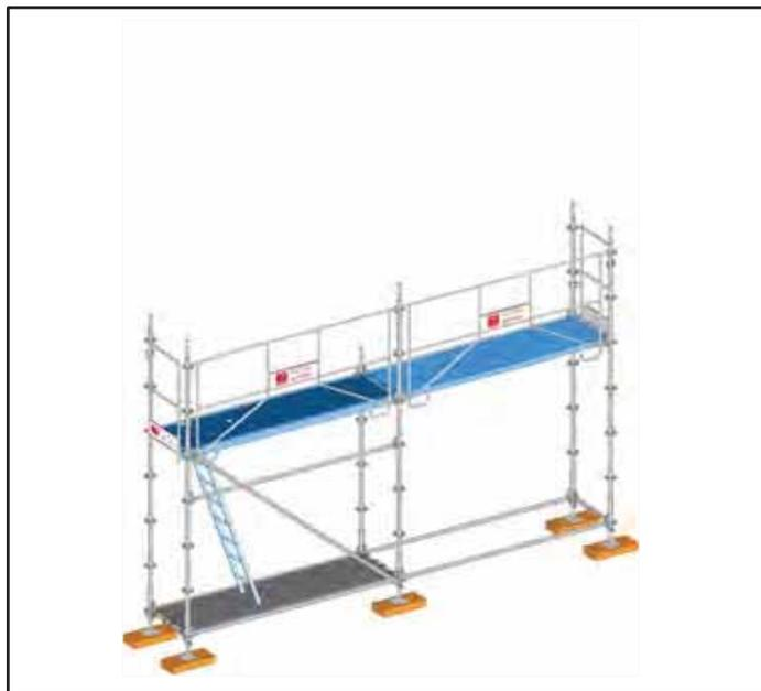
**11-** Accès en sécurité au niveau 2 mètres et mise en place des plinthes.
