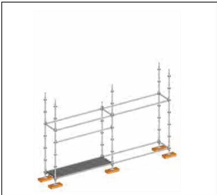
**2-** Ils s'installent avant les planchers et l'accès au niveau supérieur du côté extérieur, et aux extrémités.
