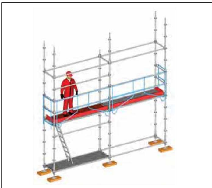
**4-** Quand un niveau est définitivement protégé, les garde-corps provisoires sont déplacés d'un étage, et ainsi de suite jusqu'au dernier niveau.
