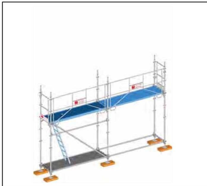
**10-** Accès en sécurité au niveau 2 mètres et mise en place des plinthes.
