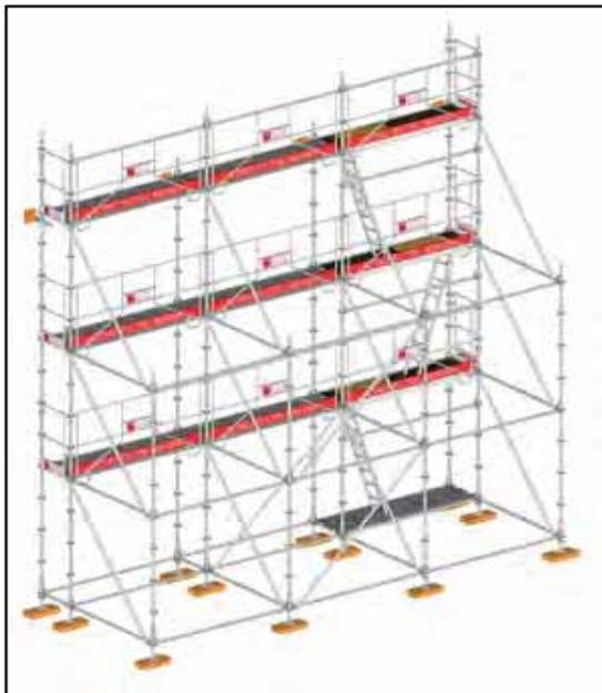
Le stabilisateur réalisé en matériel Métrix sécurise un échafaudage de façade de hauteur 6m maximum au plancher.
