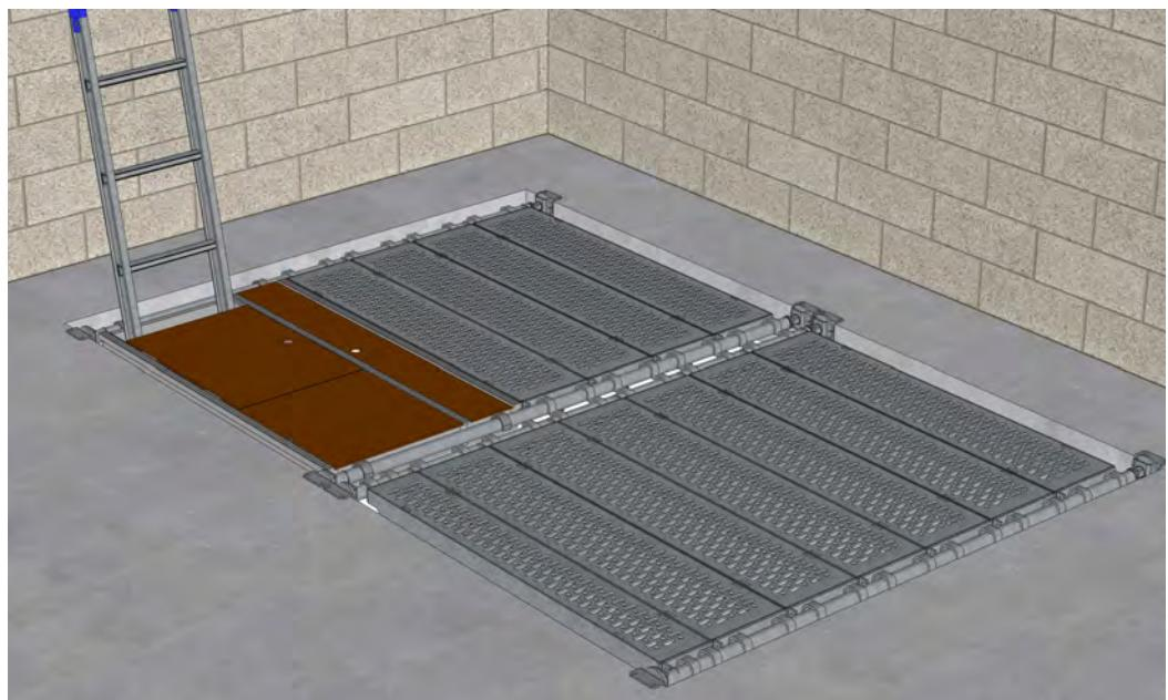
Quand la largeur de la trémie est supérieure à 150cm, il est aussi possible de doubler le tube afin de limiter les charges sur celui-ci. Pour les largeurs supérieures à 220cm, établir une note de calcul spécifique.
