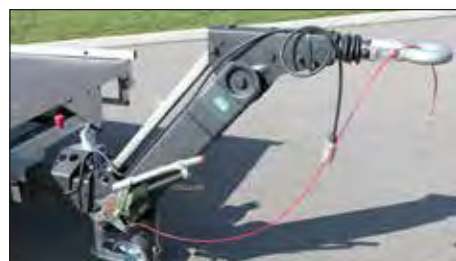
Option : Attelage timon articulé réglable en hauteur avec attache anneau 68/42 (hauteur 420 à 950 mm)
