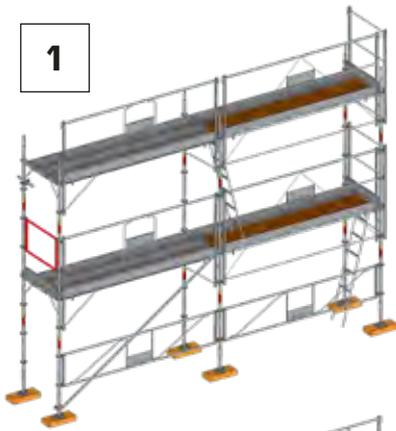
Afin de réaliser le montage ci-dessous, se reporter au chapitre « Montage standard ». Laisser une distance de 6 m entre les deux structures standard.
