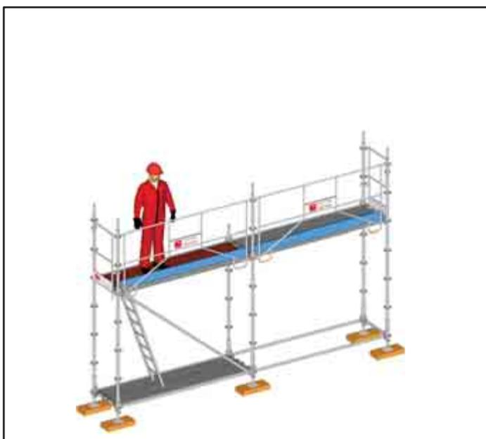
**12-** Ancrage à 4 mètres et montage ainsi de suite jusqu'au dernier niveau.
