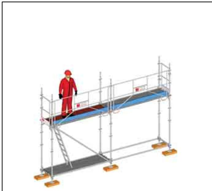
**11-** Ancrage à 4 mètres et montage, ainsi de suite, jusqu'au dernier niveau. Prévoir un cadre balcon pour dernier niveau.
