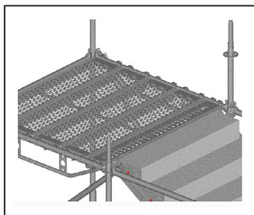
Accrocher les planchers des paliers parallèlement aux marches sur les poutrelles.
