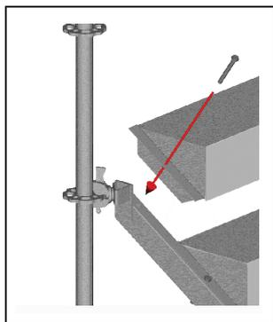
Fixer les marches sur les limons avec les vis et les écrous autofreinés. Les marches s'assemblent du bas vers le haut. Les boulons (référence KBES 12x120mm) sont livrés avec les marches.
