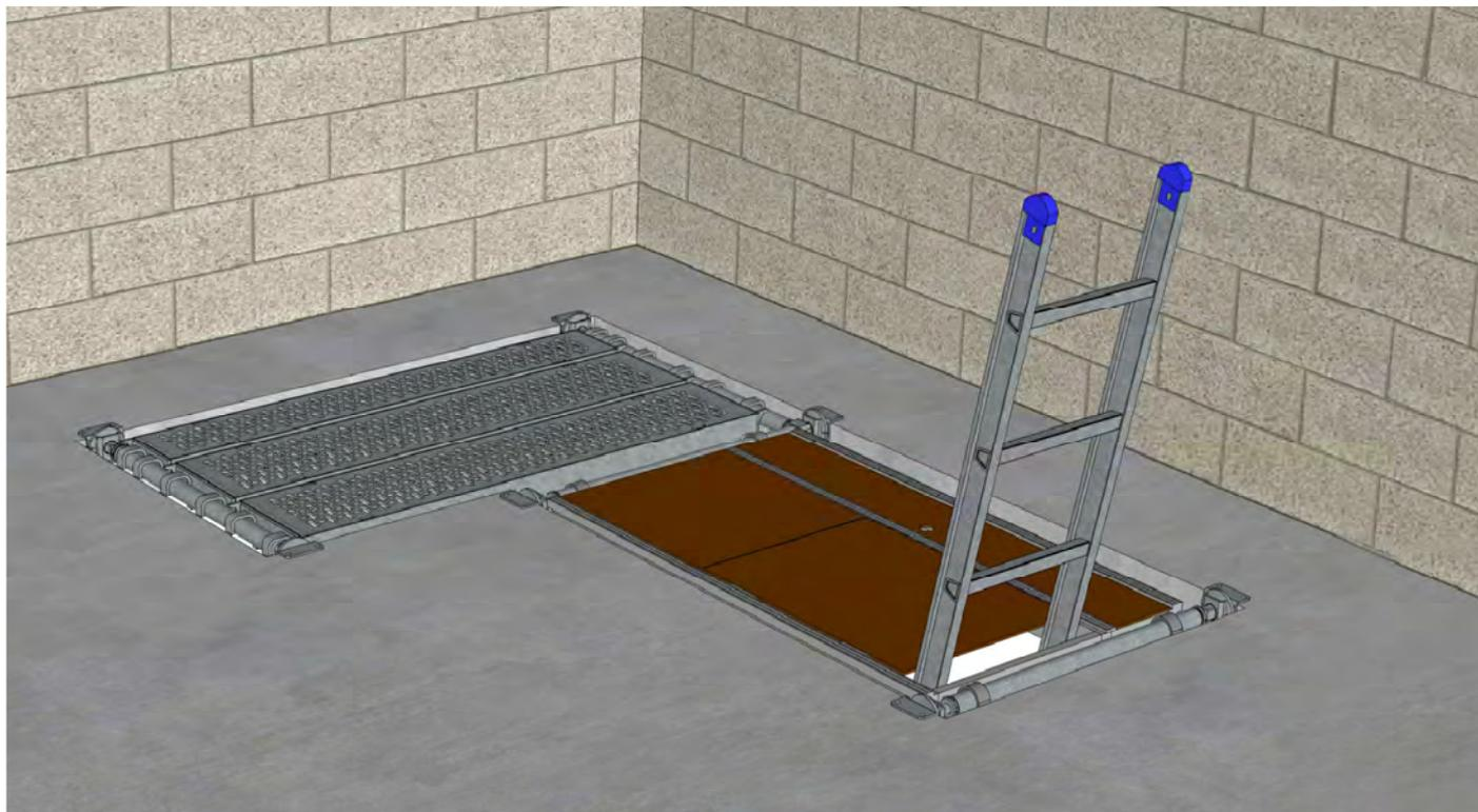
Pour les trémie en L, remplacer un vérin de trémie par un collier de reprise (réf: KCDM) afin de pouvoir accrocher le support (collier de reprise en vert ci-dessous).
