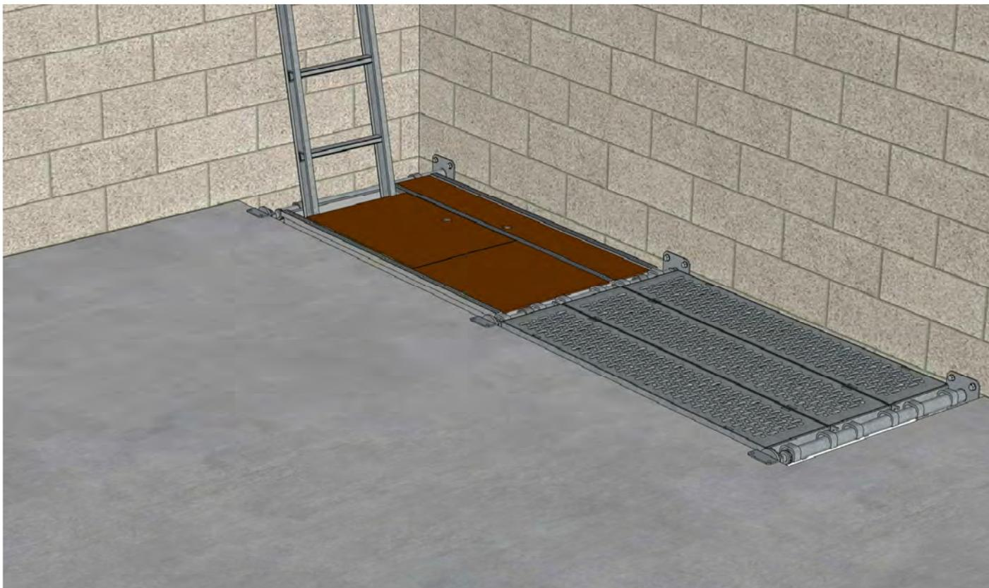
Du côté mur, remplacer le vérin de trémie par la platine pour fixation murale (réf: ASBA). La platine doit être fixée au mur avec des chevilles capables de reprendre un effort vertical de 175daN.
