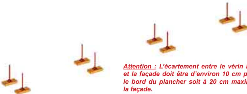
**Attention :** L'écartement entre le vérin intérieur et la façade doit être d'environ 10 cm pour que le bord du plancher soit à 20 cm maximum de la façade.
