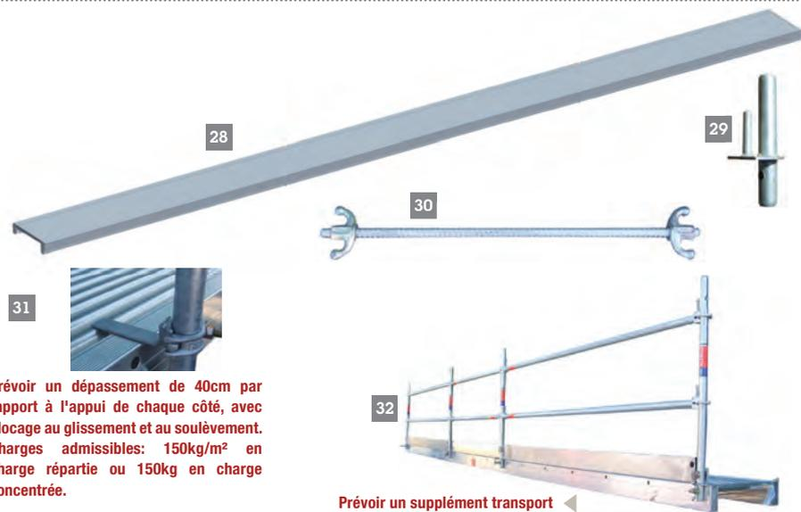
Prévoir un dépassement de 40cm par rapport à l'appui de chaque côté, avec blocage au glissement et au soulèvement. Charges admissibles: 150kg/m<sup>2</sup> en charge répartie ou 150kg en charge concentrée.
