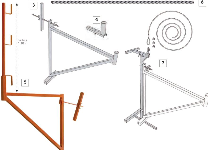
► Simple et robuste, la **console fixe de 1m** permet de positionner rapidement un plancher de travail avec ses garde-corps et un dispositif de protection en bas de pente de toiture (voir chapitre GARDE-CORPS POUR PROTECTIONS COLLECTIVES).
