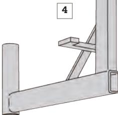
► Ces dispositifs sont conçus pour recevoir tout type de garde-corps REMY composés de poteaux Ø 40mm, de lisses galvanisées et de filets de protection. La presse rapide REMY **ne marque pas les pannes**.
