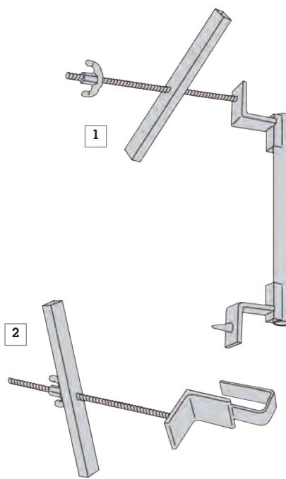
► Ces dispositifs de protection sont conçus pour les travaux de maçonnerie. Ils permettent d'installer des garde-corps de protection contre les chutes pendant l'élévation des murs. Ce dispositif est conçu pour recevoir deux types de poteaux : le **poteau à bloqueur** avec ses lisses Ø 34mm réf : 003209 ou le **poteau protecteur** pour recevoir des lisses bois.
