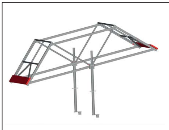
Schéma du garde-corps pour recette de matériaux. Repose sur deux étais de départ (réf. KETR).
